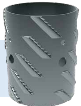
Figure 2: Une nouvelle conception de rotor utilisant des éléments inclinés et une surface ondulée au bord d'attaque des éléments. L'image de gauche montre les tubes de vitesse passant au-dessus de l'élément et démontre l'action du fluide, où la variation de couleur réfère à la vitesse. L'image de droite montre l'ensemble du rotor.
