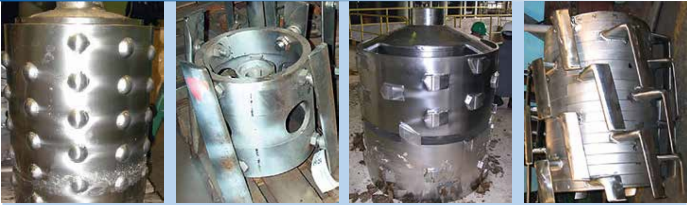
Figure 1: Différentes conceptions de rotors ont été utilisées depuis l'introduction du tamis pressurisé dans les années 1960, notamment : a) le rotor à bosses (années 1960), b) le rotor à pâles (années 1970), c) le rotor à bosses modifié (années 1990) et d) le rotor à pâles en porte à faux (années 2000).
