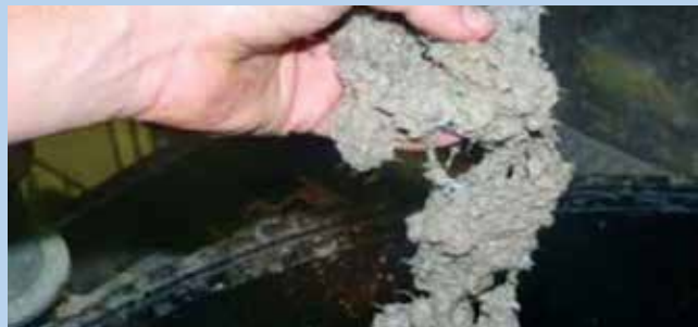
Figure 7: Les contaminants en forme de filaments peuvent s'accrocher sur les pâles du rotor et former de plus gros amas qui risquent de se coincer entre le cylindre et le rotor.
