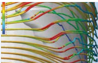
Figure 2: Une nouvelle conception de rotor utilisant des éléments inclinés et une surface ondulée au bord d'attaque des éléments. L'image de gauche montre les tubes de vitesse passant au-dessus de l'élément et démontre l'action du fluide, où la variation de couleur réfère à la vitesse. L'image de droite montre l'ensemble du rotor.
